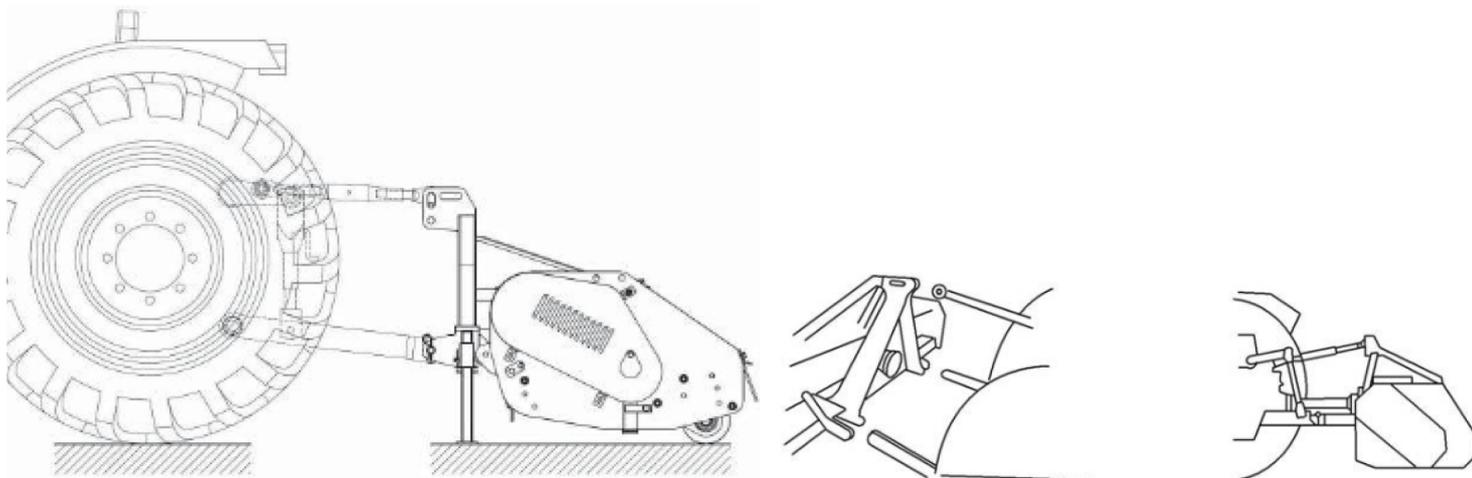
Отрегулируйте положение оборудования так, чтобы ось редуктора была параллельно поверхности земли. Это необходимо для правильной работы оборудования, что продлит срок его службы.
