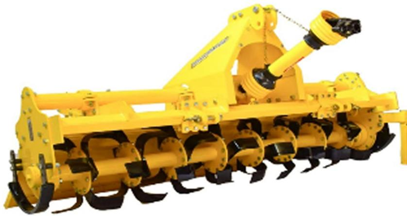
Почвофрезы серии АF предназначены для использования в сельском хозяйстве для обработки почвы под посевные грядки.
